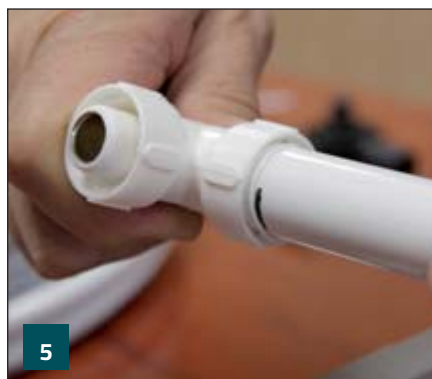
5 Retirar de las matrices el tubo y el accesorio, unirlos sin rotar ni girar hasta llegar a la línea marcada en el tubo y mantener firmemente durante el proceso de fusión.
