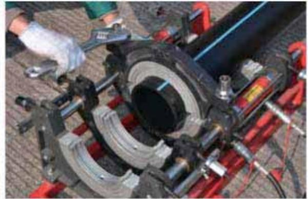
2. Los extremos de las tuberías son recortados usando un cortador rotativo para sacar las irregularidades y capas oxidadas. Las caras de los extremos recortados tienen que estar a escuadra y paralelas.
