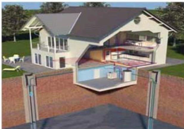
El sistema de tuberías de PE de VASEN para la aplicación de climatización geotérmica
