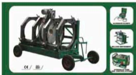
MÁQUINA DE SOLDAR A TOPE 800MM
