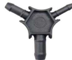
Se emplea para ello un escariador, de tal manera que se introduce en la tubería (según el diámetro), se realiza rotación y se empuja para eliminar las rebabas y bordes ásperos o cortantes. Una incorrecta calibración produce daños en la junta tórica en la inserción.
