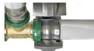
casquillo metálico, justo al lado de la pieza de color rojo (porta-casquillo), bajo ningún concepto sobre esta. Una vez realizado el prensado, retirar la mordaza e inspeccionar la junta para asegurar la prensa completa.
